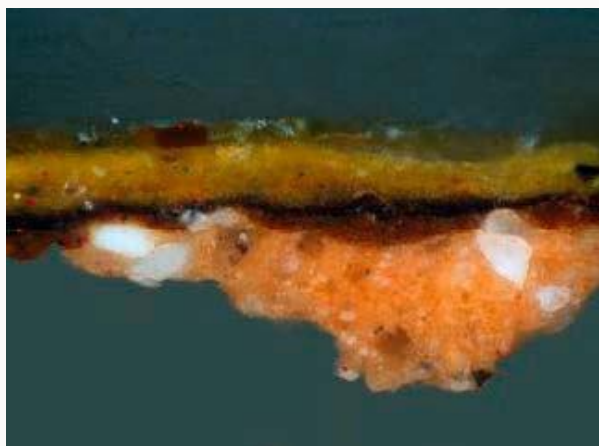
Sección transversal de una micromuestra de color amarillo. Pigmento de amarillo de plomo y estaño. Objetivo MPlan(20 X / 0,40)
