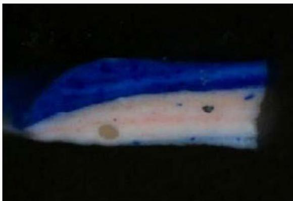
Sección transversal de una micromuestra tomada del azul de la fuente. Pigmento de azul de cobalto.
