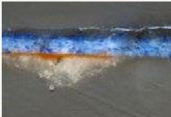
Sección transversal de la micromuestra tomada del azul de la banda. Pigmento de azul ultramar. Objetivo MPlan (20 X / 0,40)
